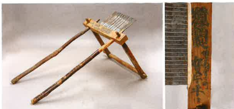
写真8 倉吉産千歯扱き 「精錬鋼製 伯耆國倉吉町 松田宇平作」
