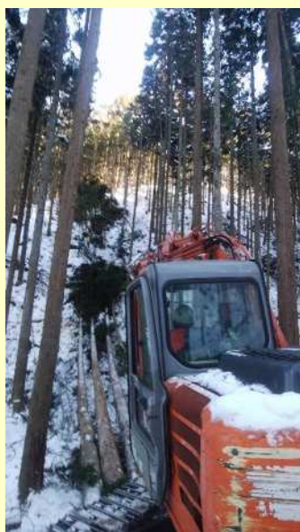
スイングヤーダーによる 列状間伐での集材の様子
