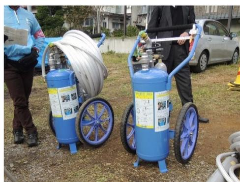
高粘度液体を用いた消火装置
