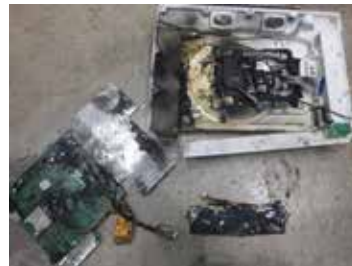
▲充電式電池を抜かずにごみに出され、火災の原因となったポータブルブルーレイディスクプレーヤー
