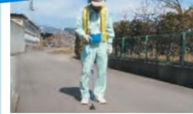
漏水探知機などの機器を使用して水道管の漏水箇所や破裂箇所の調査発見を行います。
