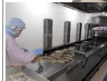
【揚げ焼き室】揚げ物・焼き物・蒸し物の調理をする部屋です。6つのスチームコンベクションオープンと、2つの揚げ物機があります。
