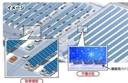
✓積雪対策として、自動落雪設計・融雪設備を導入したメガソーラーを設置することにより、積雪時でも発電ができる環境を構築している
