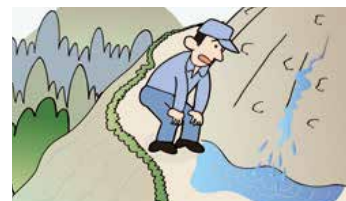
③斜面から水が噴き出す
