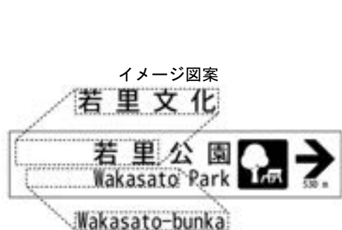
(短期メンテナンス) 修正用シートの貼付
