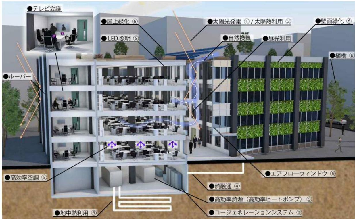
エアフローウィンドウ：二重ガラス窓の間を室内の空気では換気し、断熱性や空調の負荷を軽減する仕組み。
