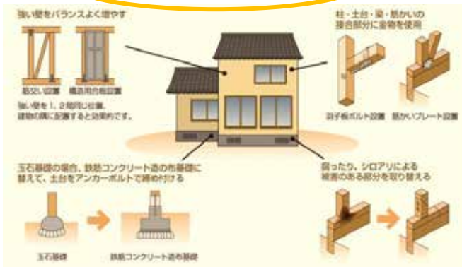
木造住宅の耐震化の例
