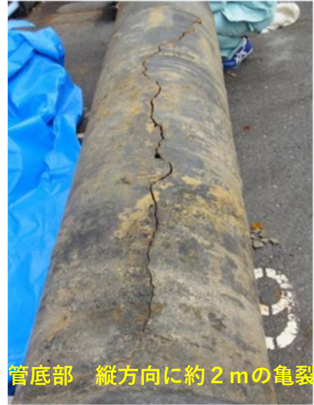
高級鑄鉄管 口径 500 mm 昭和40年布設 若槻団地 平成30年11月13日破裂
