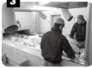
袋から出されたプラごみがベルトコンベアで運ばれ、手作業で不適物を取り除きます。全体の約10%が異物。これで多少少ない方だとか…。
