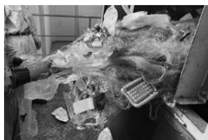
「資源プラスチック」の対象とならないプラスチック製品(ネット類)が処理する設備にからまっています。
