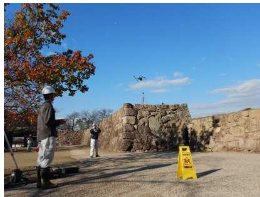
松代城跡 石垣三次元測量
