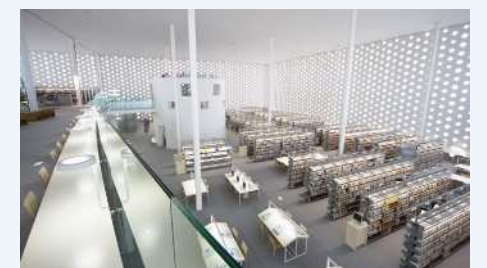
壁のパンチングが柔らかな光を取り入れる
