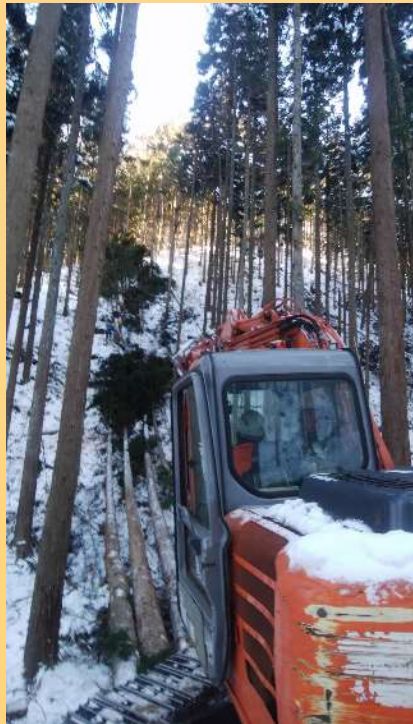
スウィングヤーダによる列状間伐での集材
