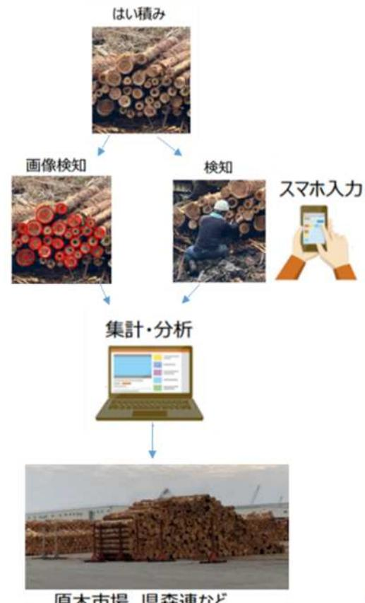
スマホで計測したり、計測した数値を入力することにより、伐採した木材の量を集計できる。
