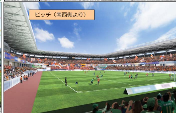
南長野運動公園総合球技場整備工事 工期：H25.12.17～H27.2.27 請負額：7,530,840千円 内容：建築面積 約13,900㎡ 延べ床面積 約26,300㎡ 地上4階鉄筋Co造 収容人数 約15,300人 照明1,500Lx グランド・天然芝（L=120m×W=80m）サッカー、ラグビー、アメリカンフットボール対応
