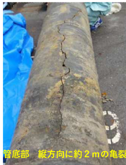
高級鑄鉄管 口径 500 mm 昭和40年布設 若槻団地 平成30年11月13日破裂
