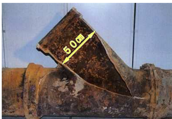
鑄鉄製Y字管 口径 500 mm 昭和36年布設 昭和通り 旧市民会館前 平成12年7月5日破裂
