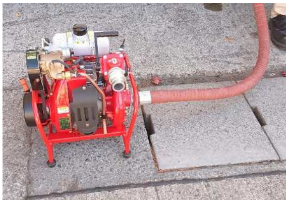
(参考) 持ち運びがしやすく操作が簡単な可搬型D級ポンプ
