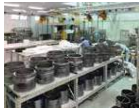
2018年に新設した大型の素材工場。洪水大園であるタイ工場の水害対策に準じた設計(床上1.5m以上にプレス機のポンプを設置)だったため、比較的早期に復旧できた
