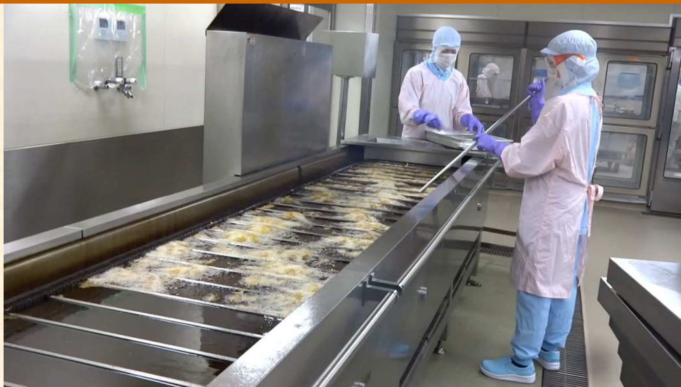
連続フライヤーで揚げ物の調理
