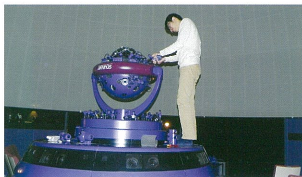
▲高所恐怖症だとちょっとつらい？恒星用電球の交換風景。
