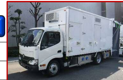
【移動式解体処理車】 車内で一次処理（皮剥ぎ、内臓摘出）後、ジビエ加工センターに運搬
